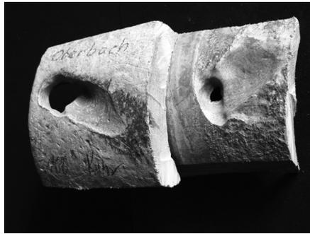
*Deutlich erkennbar sind die zwei Löcher im Eternitrohr und in der Muffe, welche die Rohre zusammen hält.*
